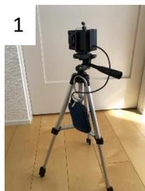
三脚にスマホホルダーに取り付け、センサーと反射板を設置します。
