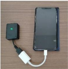
白いOTG接続ケーブルを使用して、受信機とiOS端末を接続します。これだけで電源が供給されます。
