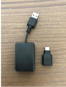
TypeC変換プラグを使用して受信機とandroid機器と接続します。
